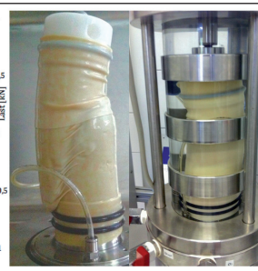
Abb. 3: Abgescherte TL-Probe infolge etappenweiser Walzenüberfahrt
