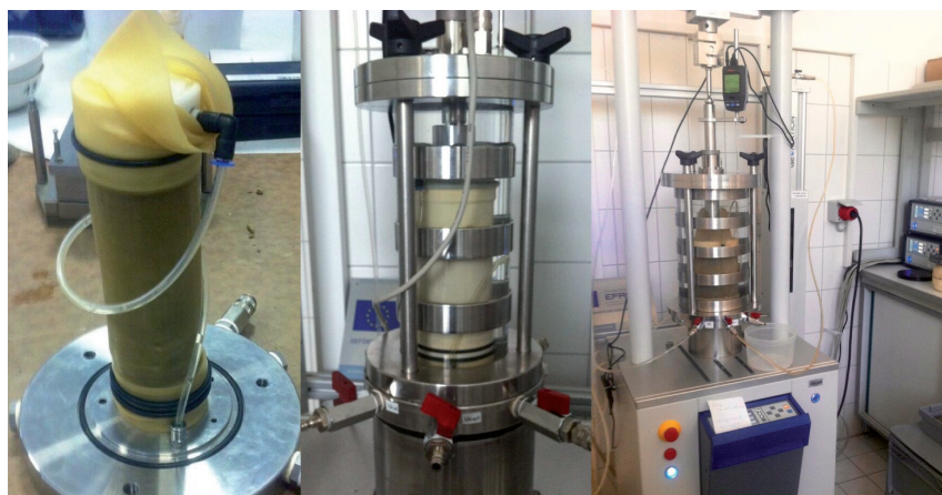
Abb. 1: Triaxialer Prüfstand und Druckzelle
