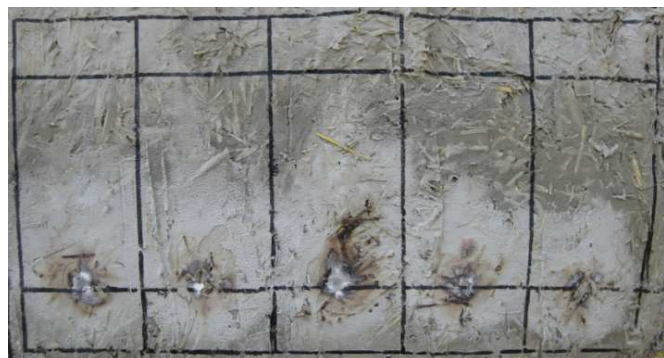
Abb. 3: Prüfschema zur Ermittlung der Baustoffklasse
