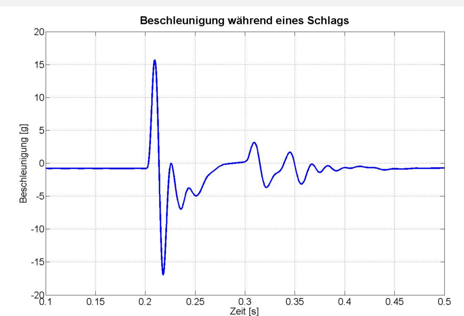
02 RAPID IMPACT COMPACTOR – PRINZIP HAMMER UND AMBOSS
