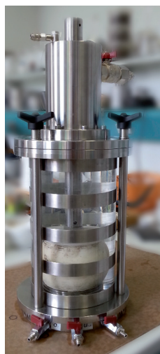
Abb. 2: Hochfrequenz-Triaxialzelle mit volumenkompensiertem Druckausgleicher
