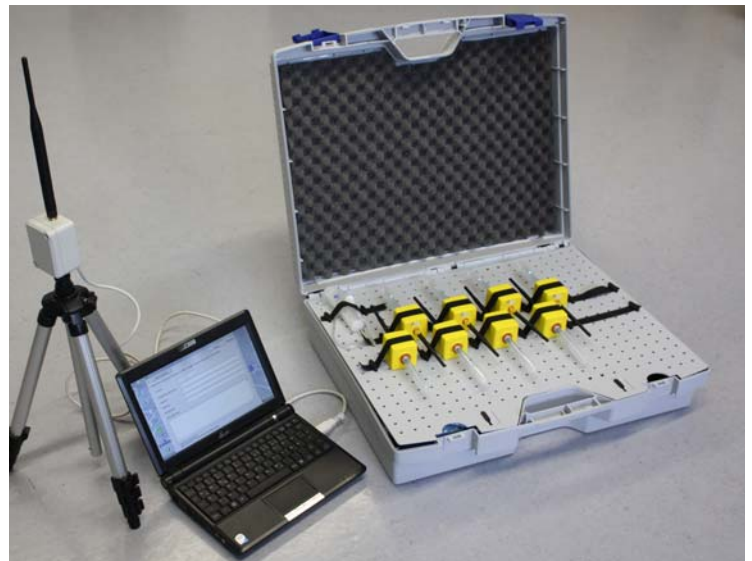
Alle relevanten Größen für die Frührisbildung von Beton mit einem Sensor messen: Hier ein Vorgängermodell des geplanten Prototyps – bestehend aus den Sensoren, der Basisstation sowie einem Notebook mit der Messsoftware
