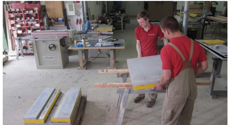
Fertigung von Textilbeton-Fassadelementen: Die Wissenschaftler der HTWK untersuchen, wie sich das thermische Verhalten des Textilbetons in neuartigen Baukonstruktionen verbessern lässt.
