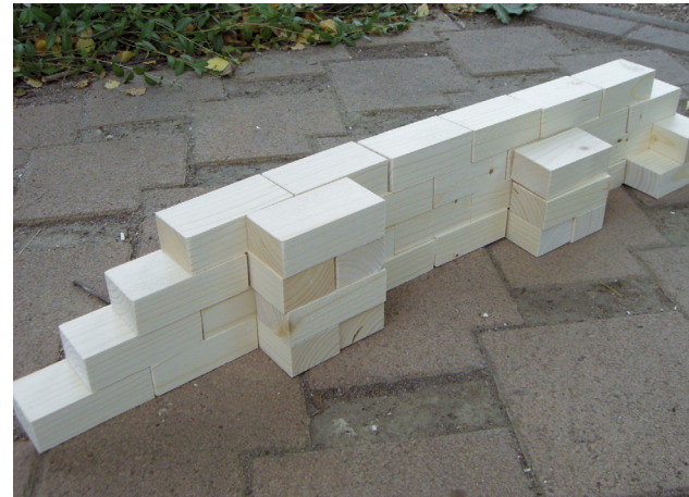
Vorüberlegung zum Aufbauschema der Testwand
