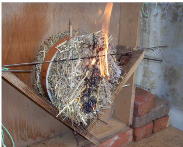
Flächenbeflammung: unbehandelte Strohoberfläche, \rho \sim 110\text{ kg/m}^3
