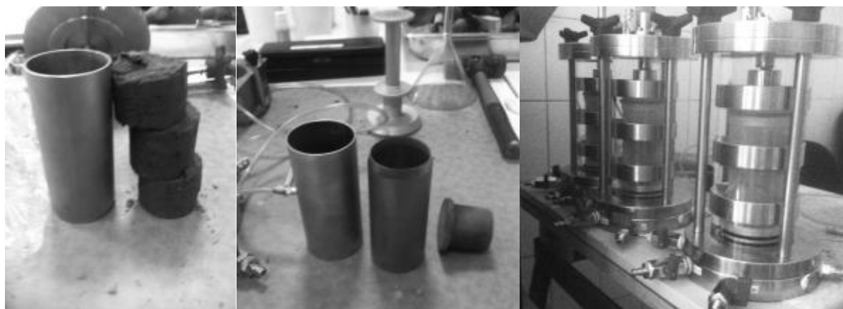
Abbildung 4: Zonenbruch, Ausstechequipment und drei vollständige Druckzellen von TL.
