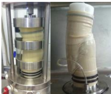
Abbildung 17: Abgescherte TL-Probe aus Phase 2 Simulation Walzenüberfahrt.
